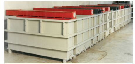
Abb. 4: Behälterreihe einer Galvanikanlage mit Absaugstegen
