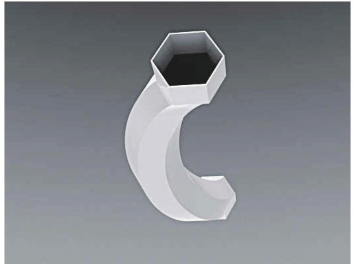
Die einzelnen Strömungskanäle des Tropfenabscheiders sind wendelförmig aufgebaut
